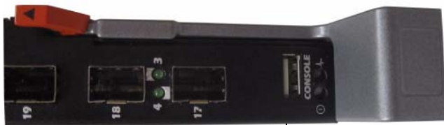
図 1-4. PowerConnect M8024-k USB コンソールポート
